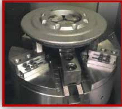
Resim 5: 10 numaralı operasyon (İçten dışa doğru ve aşağı doğru birlikte sıkma)
