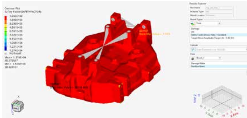
Şekil 2.21 : Mevcut (EN-GJL-250) ön dingil mesnedi yorulma analizi sonucu
