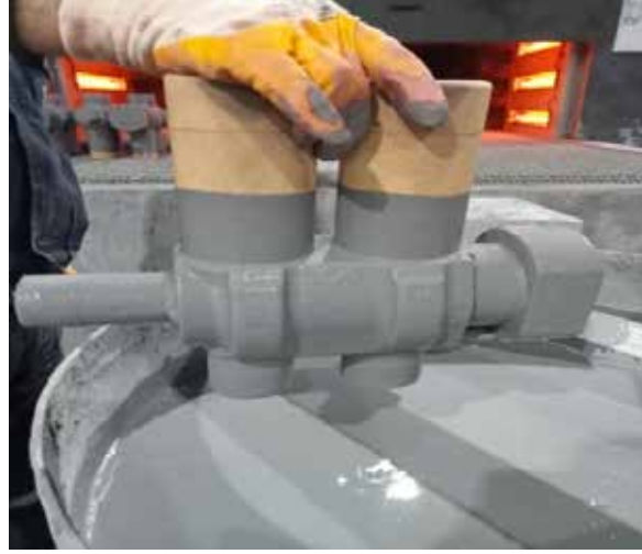
Resim 3 : Daldırma yöntemi ile boyanan maça
