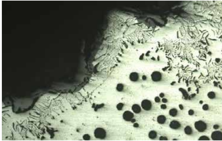
Şekil 8: Balık gözü parçasının mikroyapı görüntüsü (100 büyütme).
