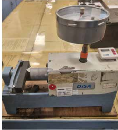
Şekil 6: Kırılma mukavemeti ölçüm cihazı
