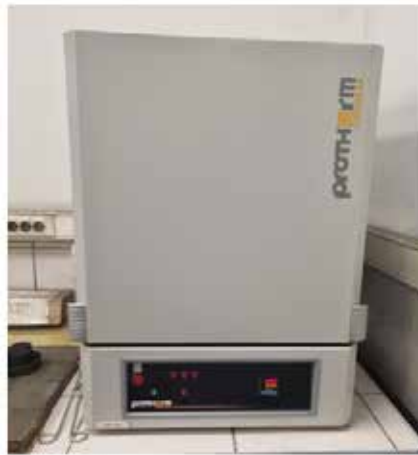
Şekil 7: Yanma kaybı ölçüm fırını
