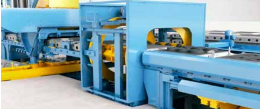
Resim 5 : Kalıpların Üzerinde İlerlemesini Sağlayan Rulman ve Raylardan Oluřan Kalıp Konveyörü
