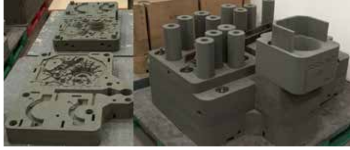
Şekil 3: 3D yazıcı ile üretilmiş maçalar ve kalıp
