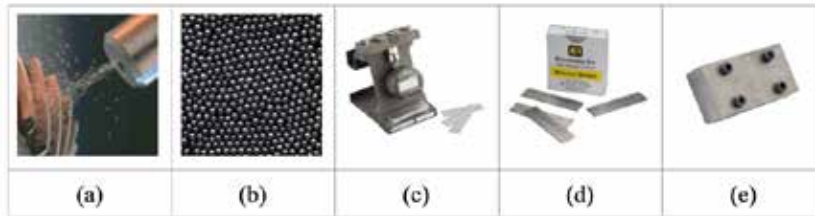
Şekil 3 : Bilyalı dövme işleminde kullanılan ekipmanlar a) Bilyalı dövme, b) Bilye, c) Almen gage, d) Almen strip, e) Almen holder [20]
