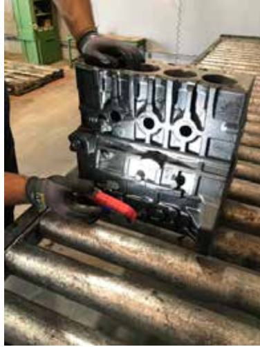
Şekil 4: Yüksek Lümenli Işık ile Parça Kontrolü
