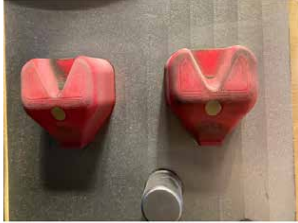
Resim 5 : ABS malzemesi kullanılarak üretilen besleyici kalıplama denemesi
