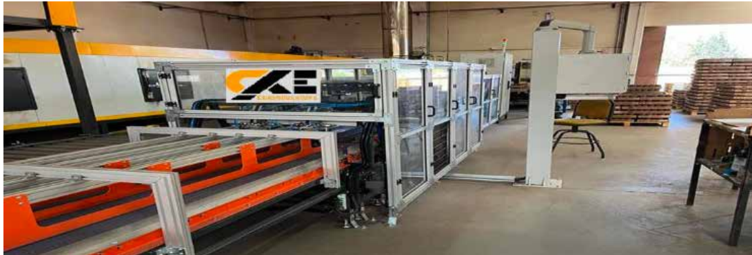
Şekil 4 : Besleyici gömlek ölçü kontrol sistemi.
