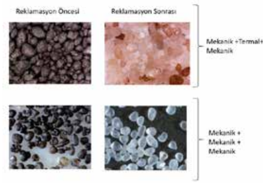
Şekil 5: Atık Kalıp Kumunun Reklamasyonu Kum Mikroskop Görüntüleri
