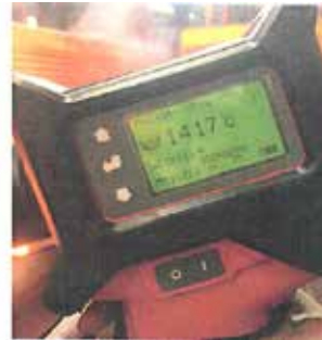
Şekil 17 : Kalıba Akıştan Ölçülen Sıcaklık
