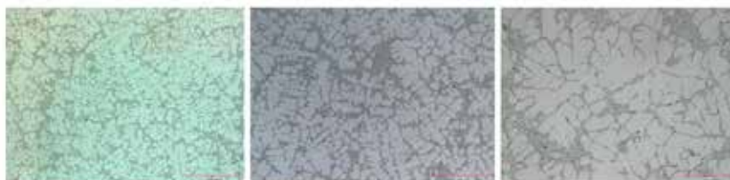
Şekil 13 Isıl işlemlili Kol-Dış Rim 25x 50x 100x mikro yapı
