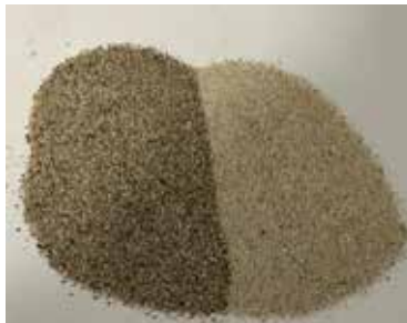
Şekil 10: Reklamasyon Çıktı Kumu İlk Deneme (Solda) ve Silis Kumu (Sağda) Fiziksel Görünüşü
