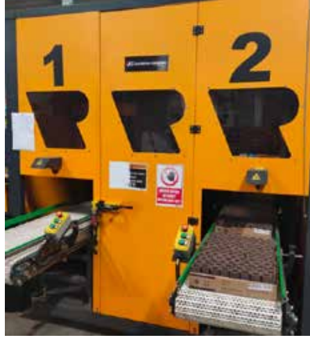
Şekil 5 : Kırıcı maça yapıştırma ünitesi.
