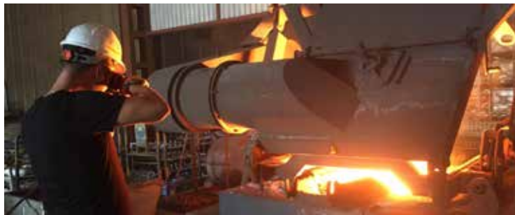
Şekil 12 : Taşınabilir Optik Pirometre ile ölçüm
