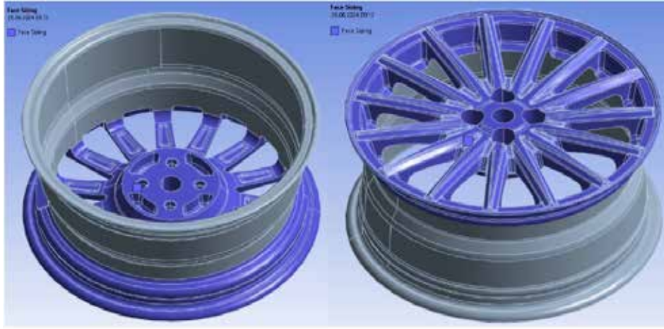
Şekil 3 : Mesh'te 8mm eleman boyutu verilen yüzeyler
