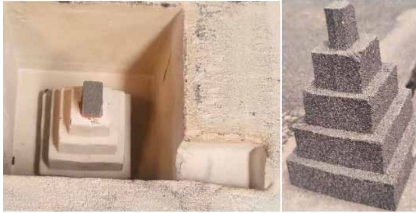
Şekil 3: Yeni nesil ekolojik furan reçinesi ile kalıplanan kum kalıp ve maça görüntüsü
