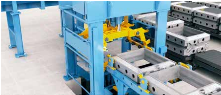
Resim 10 : Transfer Arabalarının (Palet Arabaları) Temizleme İstasyonu
