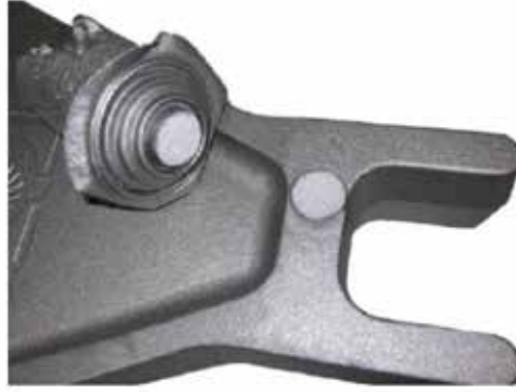
Şekil 9: Kesildikten sonra noktasal besleyici, minimum boyun ile kalır.
