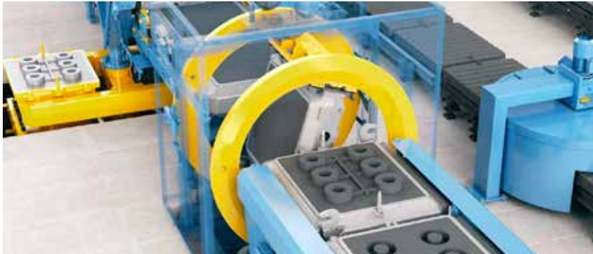
Resim 6 : Kalıpların Oluřturulması İin Derecelerin Çevrilmesini Sağlayan Kalıp Çeviriciler
