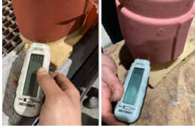
Resim 5 : Kurutma fırını öncesi ve sonrası maçanın nem kontrolü
