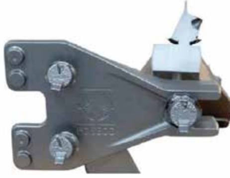
Şekil 8: (3) Eğimli noktasal besleyiciyle beslenen kamyon braketi dökümü
