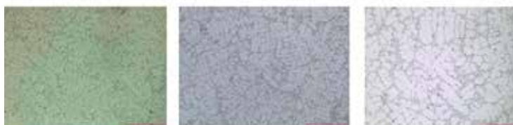
Şekil 25 3 Toz, 3 Yaş Boya Kol-Dış Rim 25x 50x 100x mikro yapı
