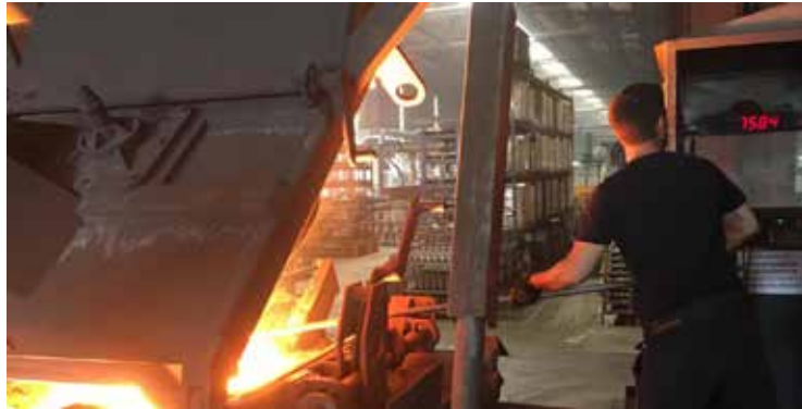
Şekil 11 : Daldırma Tip Kartuşlu Termokupl ile ölçüm
