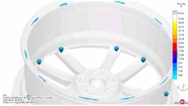
Şekil 18 : 8,5x21" jantı MAGMA simülasyonu sonucu porozite yoğunluğu öngörülen bölgeler
